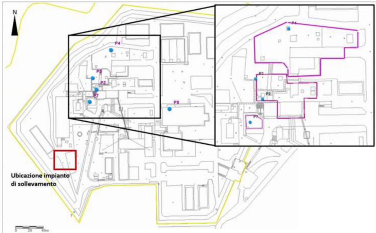
Figura 3. Ubicazione dei pozzi di emungimento e dei sistemi di isolamento idraulico nell'area Sogin ITREC - Fonte Sogin.
