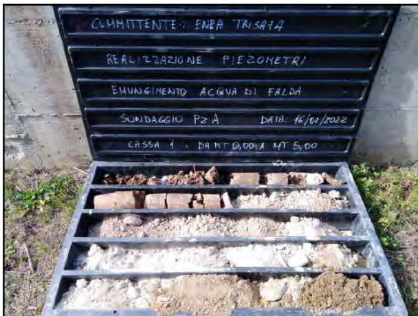
FOTO n.01 Casseta da mt 0.00 a mt 5.00
