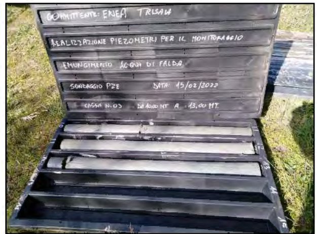
FOTO n.03 Casseta da mt 10.00 a mt 13.00
