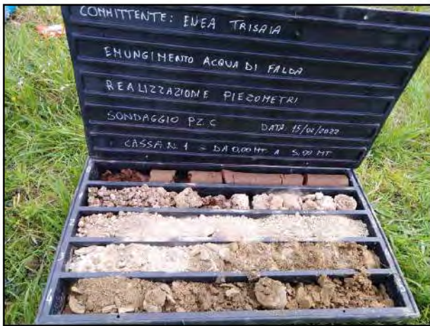
FOTO n.01 Casseta da mt 0.00 a mt 5.00
