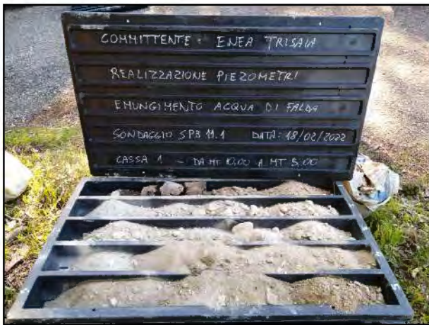
FOTO n.01 Casseta da mt 0.00 a mt 5.00
