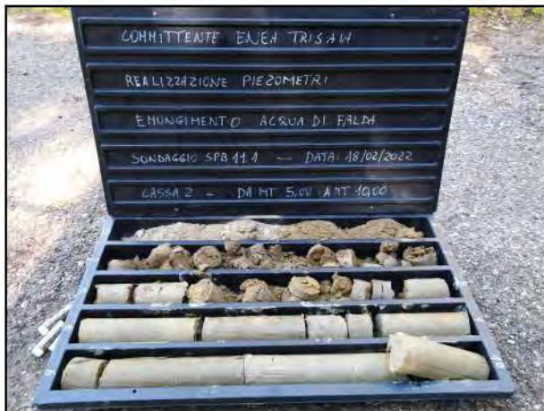
FOTO n.02 Casseta da mt 5.00 a mt 10.00
