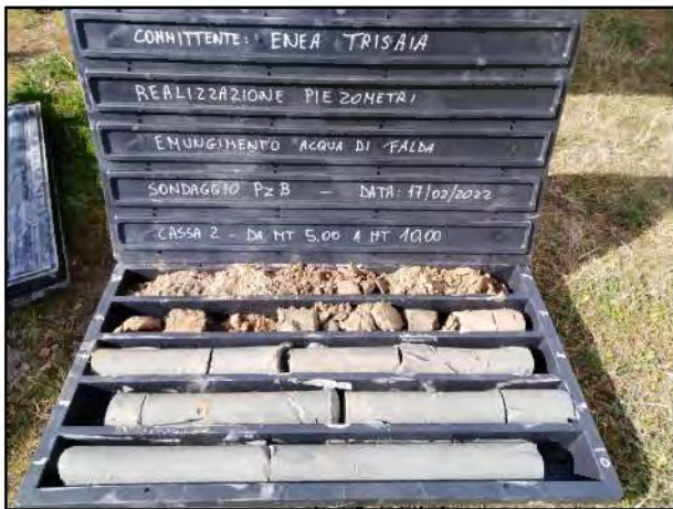
FOTO n.02 Cassetta da mt 5.00 a mt 10.00
