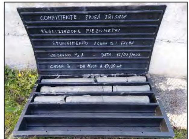
FOTO n.03 Casseta da mt 10.00 a mt 13.00
